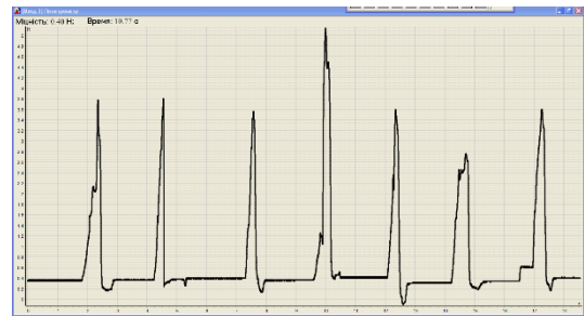
Рис. 2. Вікно програми “Лабораторія МІГ-1.3” Визначення межі міцності м’яса креветки Palaemon adspersus , зразок 1
