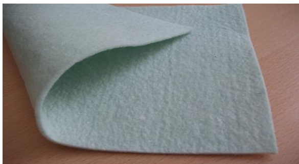
Рис. 1. Типи геотекстильних матеріалів: а – тканый; б – нетканый
