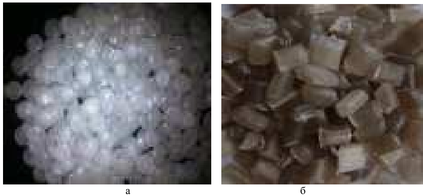
Рис. 1. Гранули поліетилену поліетилену низької густини (LDPE) (а) та гранули поліетилену високого тиску із вторинної сировини (б), що використовувались для виготовлення виробів методом екструзії
