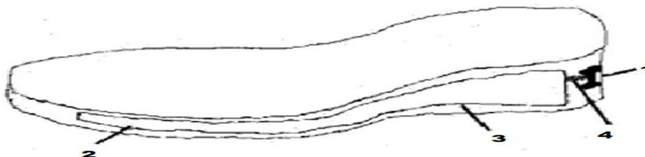
Рис. 5. [11.] Підошва для взуття із можливістю коригування висоти (прихована система «ліфт»): 1 – кнопка, яка запускає пружинний механізм, 2 – пустота між верхньою та нижньою частинами підошви, 3 – нижня частина підошви, 4 – пружинний механізм.
