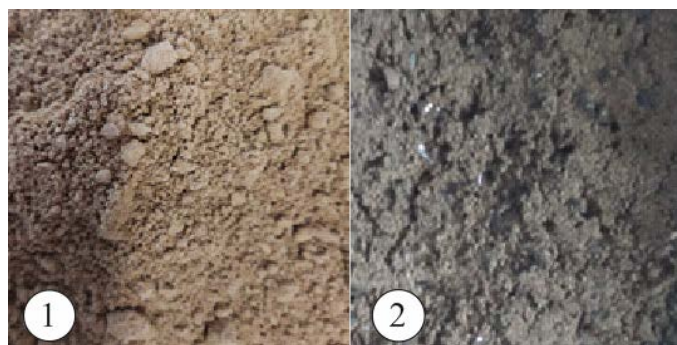
Рис. 1. Загальний вигляд зразків: 1 – зола виносення Миколаївської ТЕЦ; 2 – суглинок лесовий.
