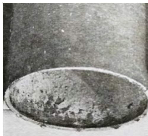
Рис. 2. Форма оплавлення торця електрода-труби при кільцевій ЕШН
