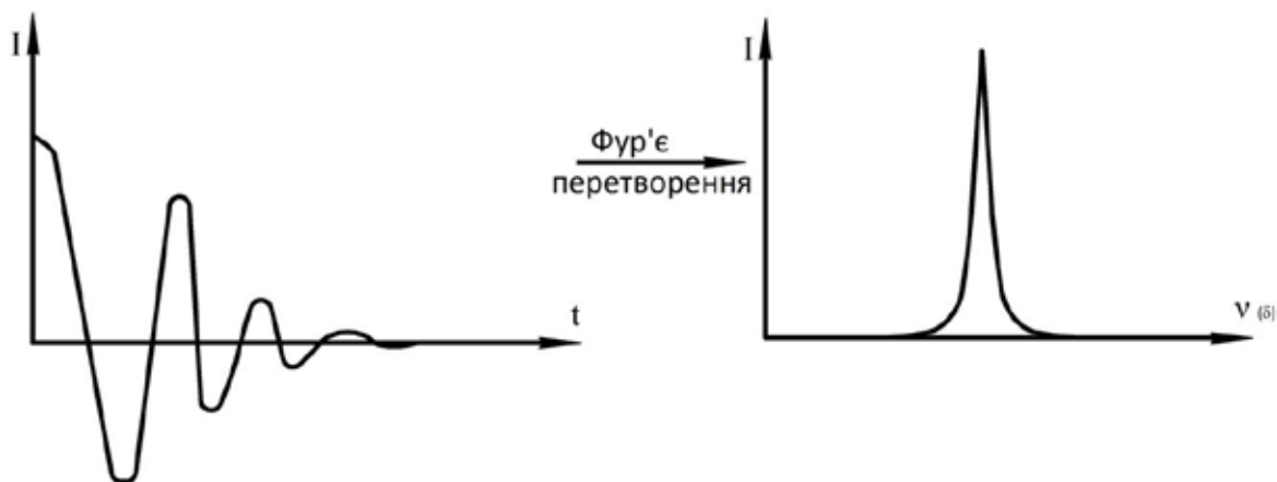
Рис. 5. Сигнал спаду вільної індукції та отриманий спектр ^1\text{H} ЯМР з Фур'є-перетворенням.
