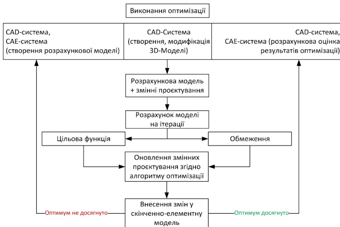
Рис. 1. Схема процесу топологічної оптимізації виробу в середовищі SOLIDWORKS
