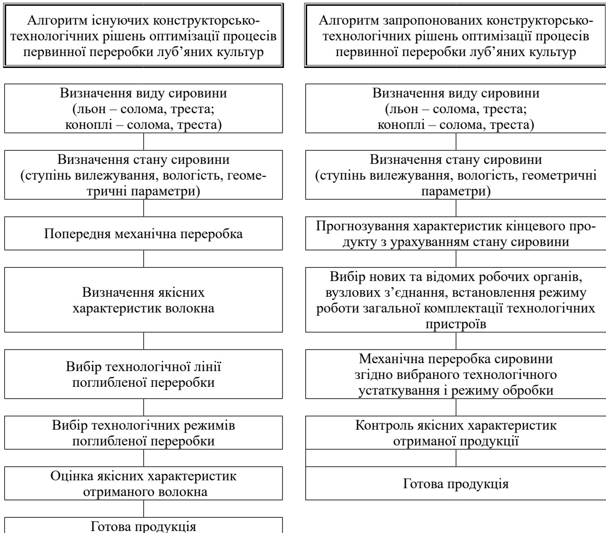
Рис. 2. Алгоритм наявного й запропонованого конструкторсько-технологічного рішення оптимізації процесів первинної переробки луб'яних культур
