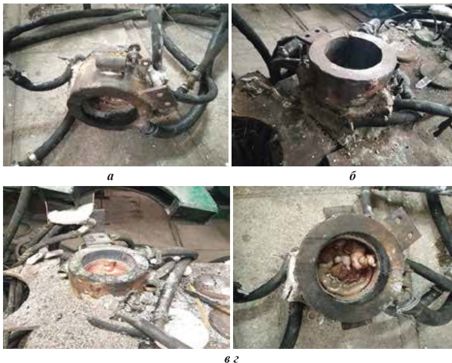
Рис. 1 – Етапи роботи експериментального струмопідвідного кристалізатора: а – підготовчий стан перед встановленням; б – ініціація процесу наплавлення; в – формування модифікованого наплавленого шару; г – завершення наплавлення та стадія охолодження
