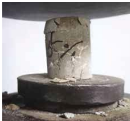
Рис. 2. Загальний вигляд руйнування зразка ґрунтоцементу із додаванням 5 % висушеного осаду каналізаційних очисних споруд
