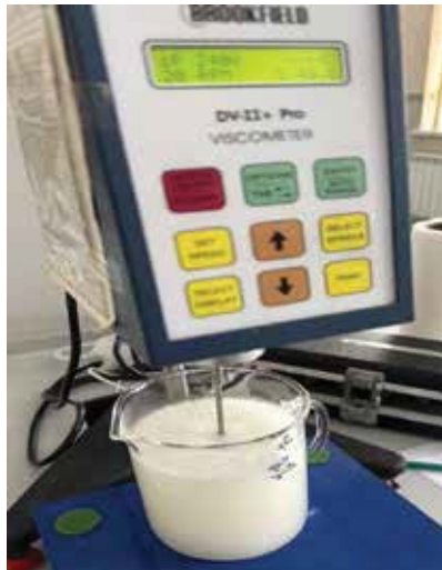
Рис. 1 Приклад робочого вимірювання на віскозиметрі DV-III+PRO
