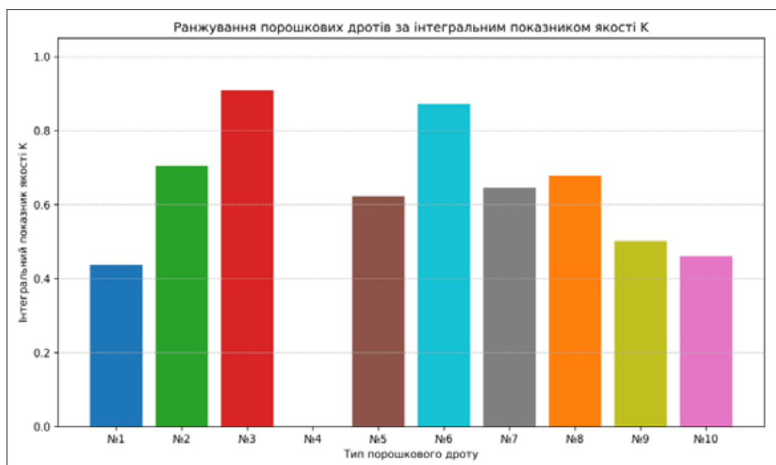
Рис. 2. Інтегральний показник якості K (норм.) для 10 типів порошкових експериментальних дротів за результатами нормування критеріїв «твердість–зносостійкість–корозійна стійкість»
