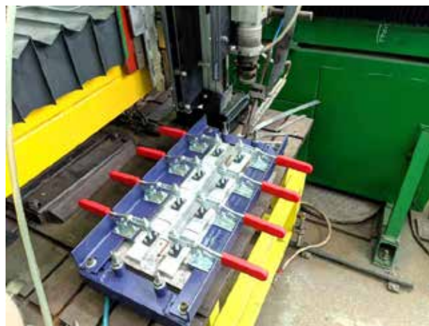
Рис. 1. Пост для лазерного зварювання
