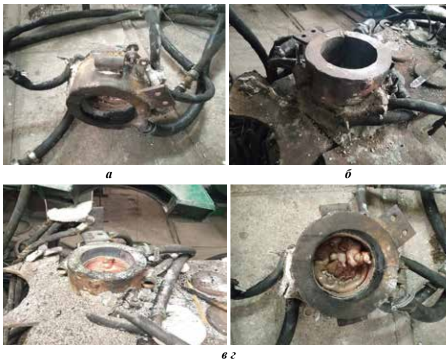
Рис. 1 – Етапи роботи експериментального струмопідвідного кристалізатора: а – підготовчий стан перед встановленням; б – ініціація процесу наплавлення; в – формування модифікованого напавленого шару; г – завершення наплавлення та стадія охолодження
