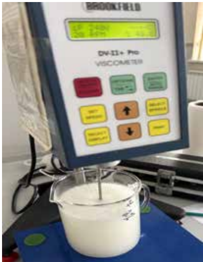
Рис. 1 Приклад робочого вимірювання на віскозиметрі DV-III+PRO
