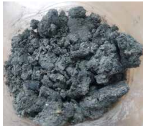
Рис. 1. Загальний вигляд сирого осаду каналізаційних очисних споруд
