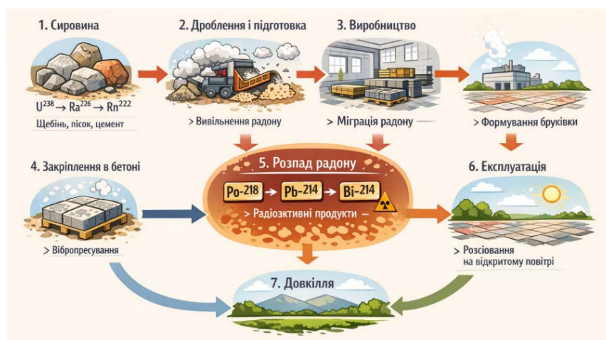
Рис. 1. Життєвий цикл радону у виробництві бруківки
